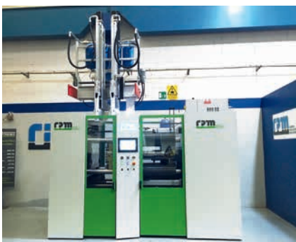
La pressa Ecotronic SmartWire Short da 200 t, equipaggiata con il nuovo blocco termoregolato C3
